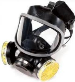
▪ **الجهاز الواقي الكيماوي:** لوقاية الجهاز التنفسي من الأبخرة والغازات الضارة، حيث يحتوي على مادة كيميائية تتميز بقدرتها على امتصاص الكميات المحدودة من الملوثات الضارة، وهذا الجهاز غير مناسب في الأماكن المغلقة مثل خزانات المذيبات العضوية، ويمكن استخدامه في أماكن غير مغلقة.
